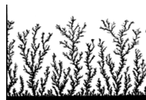
硝酸銀溶液からの銅板への銀の析出
