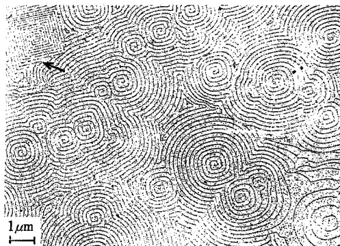
図5 昇華によってできた食塩結晶のステップのパターン。H.Bethge, Kinetics of Ordering and Growth at Surfaces, 125(1990)による。
